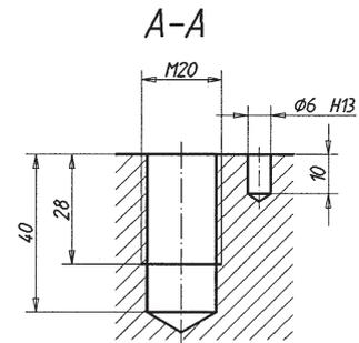
min. surface d'appui pour couvercle
