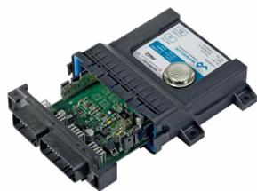
Électronique d'amplification et de régulation
