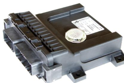
Module amplificateur / régulateur Mobile
